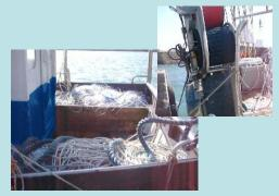
Utilisation d'un vire filet ne prenant que les cordes mères Utilisation d'une table de démaillage adjacente au vire filet Les zones de nettoyage et de stockage des filets sont séparées de la zone de stockage des poissons
